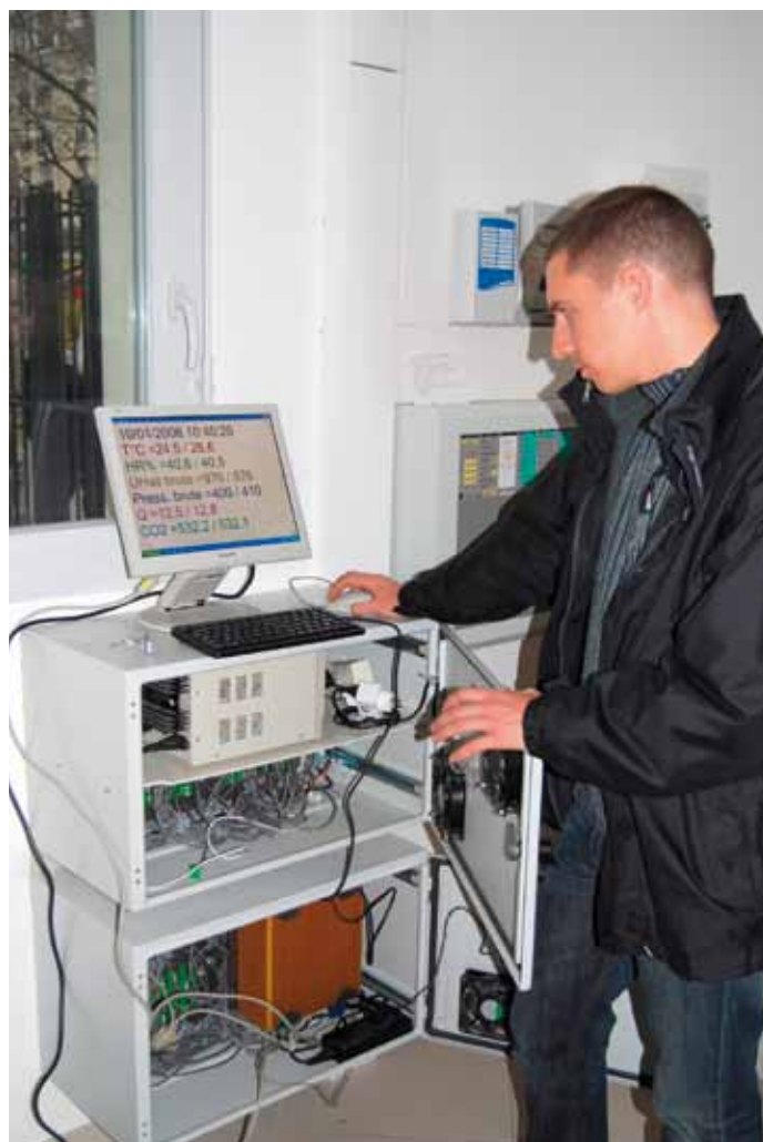
Центральная система управления для записи и хранения собранных данных. Передача организовывалась с помощью интернет-соединения.
